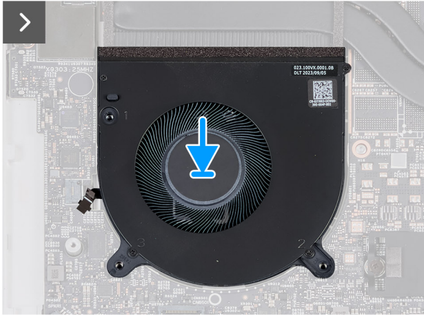
Figure 23. Installing the GPU fan
