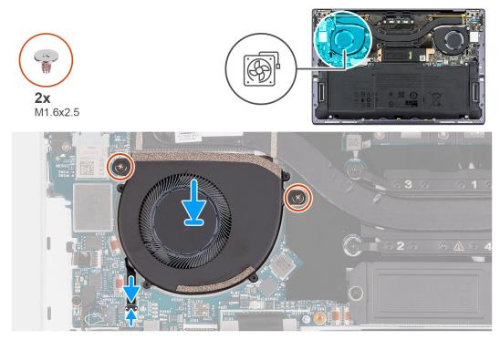
Figure 31. Installing the right fan
