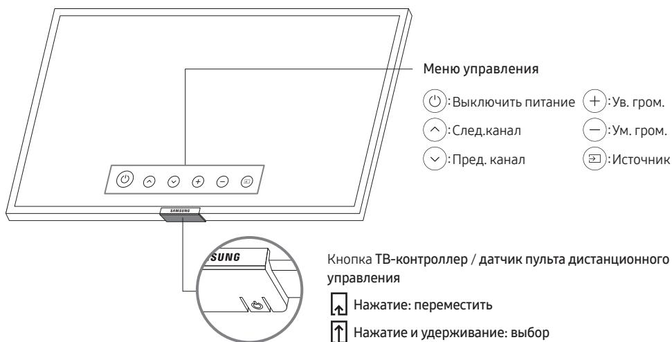
ТВ-контроллер, представляющий собой кнопку, расположен на нижней панели телевизора.
