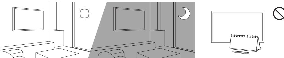
Senzorul Eco reglează automat luminozitatea televizorului. Această funcție măsoară lumina din încăpere și optimizează automat luminozitatea televizorului pentru a reduce consumul de energie. Dacă doriți să dezactivați această funcție, accesați (🏠) > ⚙️ Setări > General > Soluție Eco > Detectare lumină ambientă.
