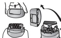
2. Säubern Sie den Schnellverschluss [B], den Scherkopf [C] und den Rasierkopf [D] mit einer Reinigungsbürste [H].
