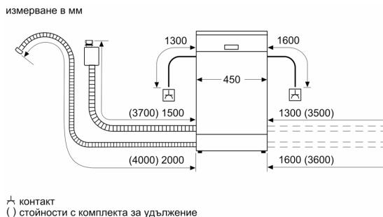
Измерване в мм
