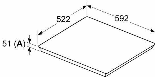
Измерване в mm
