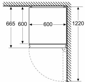
Измерване в мм
