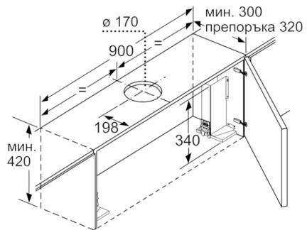
При монтаж на 90см плосък капак в 90 см широк шкаф на стена е нужен монтажен комплект. Двата монтажни винкела се завинтват отляво и отдясно в кухненския уред. Монтаж по шаблон.
