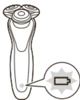
Wenn der Akku fast leer ist, blinkt die Akkuladestandsanzeige orange. In diesem Fall enthält der Akku noch genügend Energie für eine Rasur.
