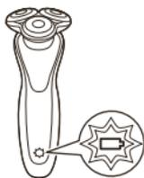
Schnellaufladung: Nach ca. 5 Minuten Ladezeit hat der Rasierer genügend Energie für eine Rasur. In diesem Moment hört die Akkuladestandsanzeige auf, schnell zu blinken und blinkt stattdessen langsam.
