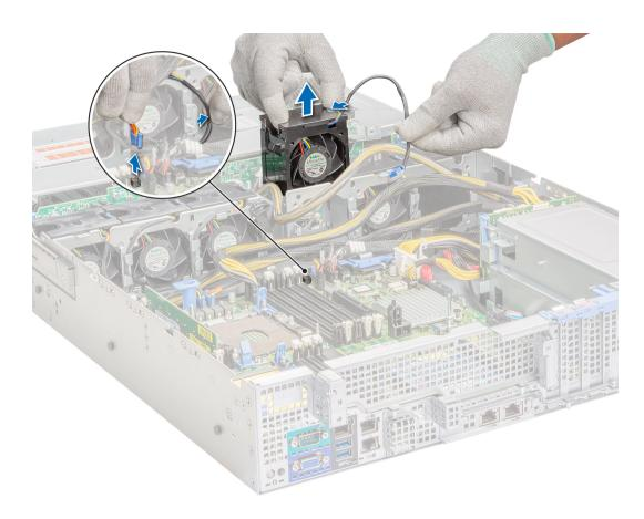
Figure 29. Removing cooling fan
