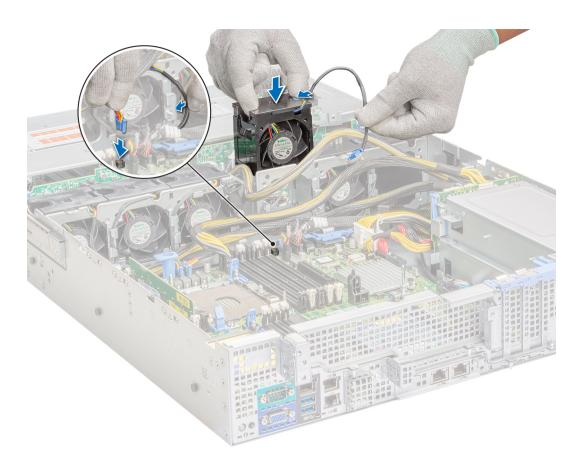
Figure 30. Installing cooling fan
