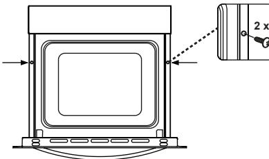
Introduzca el horno en el armario empujándolo. Abra la puerta del horno e introduzca dos tornillos en los orificios que se encuentran en la estructura del horno. Mientras la estructura del producto toque la superficie de madera del armario, apriete los tornillos.
