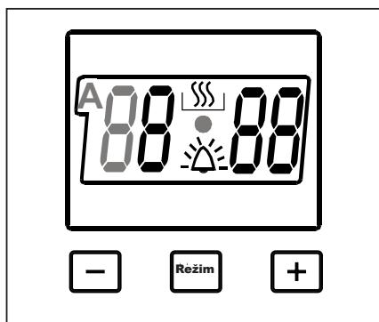
Před použitím trouby je třeba provést nastavení času. Po zapojení trouby do napájení začne symbol (A) a tři "0" na obrazovce blikat. Současně stiskněte tlačítka (+) a (-).
