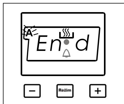
Poté přidržte tlačítko MODE (REŽIM) dokud se na obrazovce nezobrazí "end" (konec). Když se na obrazovce zobrazí "konec", kromě doby vaření se na obrazovce rozblíká také symbol (A) a čas. Zatímco je časovač v požadované pozici, nastavte čas dokončení vaření jídla pomocí tlačítka (+) a (-). Chvíli po dokončení nastavení se na obrazovce zobrazí čas a na obrazovce se rozsvítí symbol (A).
