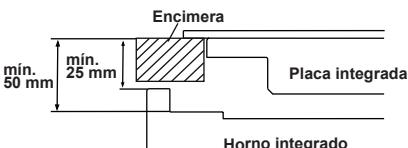
Si el horno se instala debajo de una placa, la distancia entre la encimera y el panel superior del horno debe ser de 50 mm como mínimo, y la distancia entre la encimera y la parte superior del panel de control debe ser de 25 mm como mínimo.
