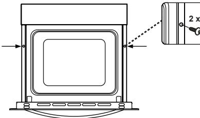
Schieben Sie den Backofen vorwärts in den Schrank. Öffnen Sie die Backofentür und setzen die beiden Schrauben in die Löcher im Rahmen des Ofens. Wenn der Rahmen des Backofens die Holzoberfläche des Schranks berührt, ziehen Sie die Schrauben fest.
