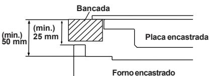
Se o forno for instalado sobre uma placa de fogão, a distância entre a bancada e o painel superior do forno deve ser de, no mínimo, 50 mm e a distância entre a bancada e o cimo do painel de controlo deve ser de, no mínimo, 25 mm.
