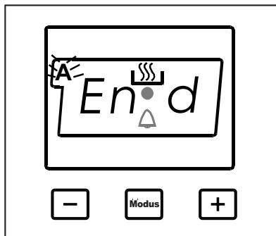
Drücken Sie die MODE-Taste, bis Sie „End“ auf der Timeranzeige sehen. Wenn Sie „End“ auf der Timeranzeige sehen, werden das (A) Symbol und die Tageszeit anfangen zu blinken, unter Angabe der Kochdauer. Passen Sie die Zielzeit durch Drücken der (+) und (-) Tasten an, während sich der Timer in dieser Position befindet. Eine Zeit nachdem die Konfiguration abgeschlossen ist, erscheint die Tageszeit wieder auf dem Bildschirm und das (A)-Symbol wird fortwährend auf der Anzeige zu sehen sein.
