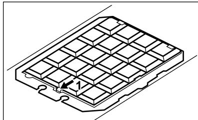
3. Führen Sie zum Einbau des neuen Filters die gleichen Schritte in umgekehrter Reihenfolge durch. Auf jeden Fall müssen die Filter mindestens alle vier Monate ausgetauscht werden.
