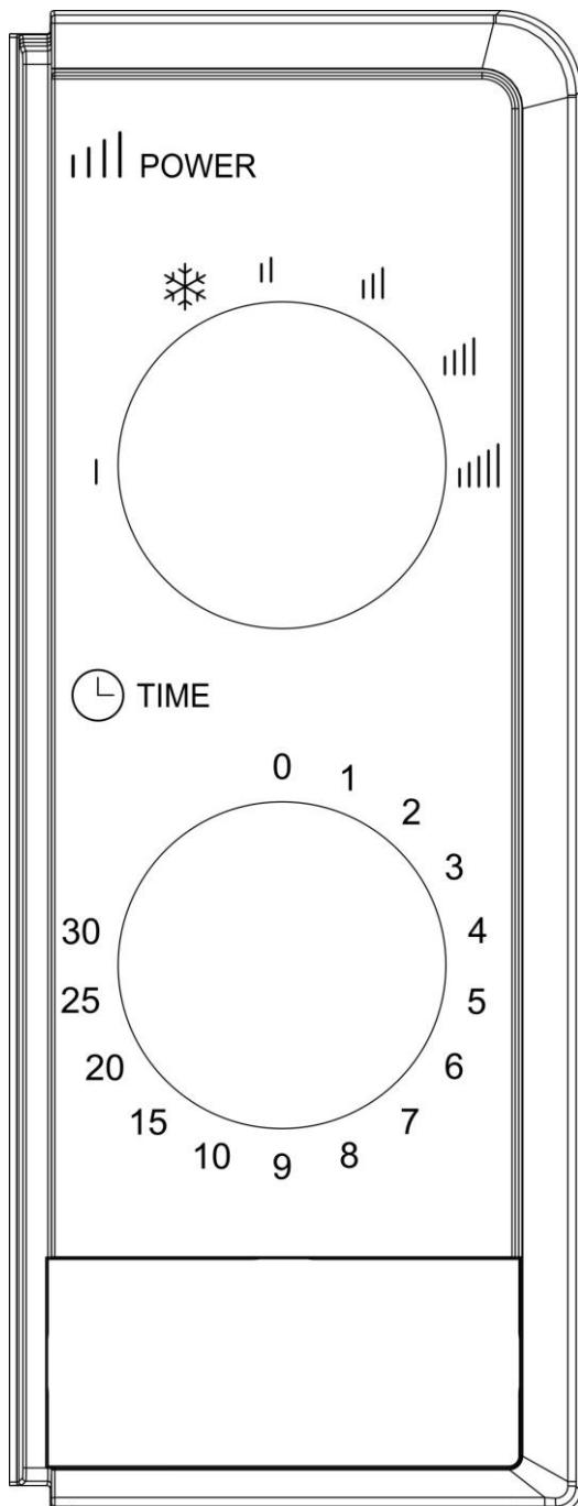
Контролният панел се състои от две функционални копчета. Едно е копчето на таймера, а другото е копчето за мощност.
